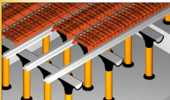
COLOSSEO h > di 45 cm con travetti in c.a.p.
