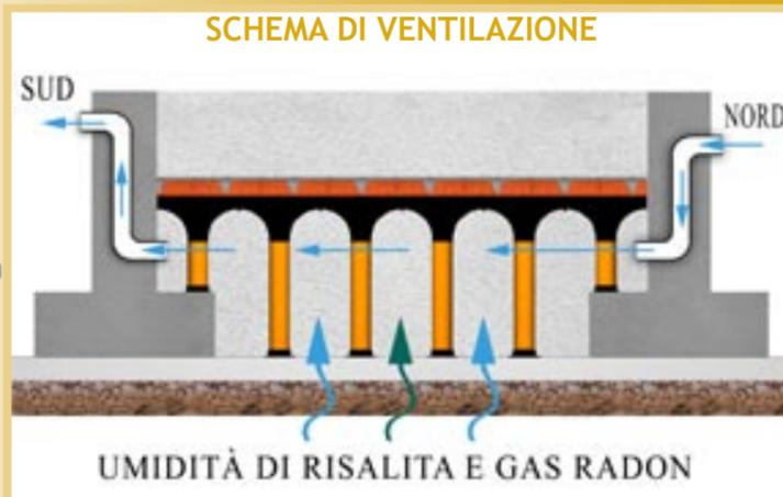
Il GAS RADON che affiora dal sottosuolo viene disperso in atmosfera attraverso i tubi di ventilazione disposti opportunamente sulle pareti esterne del vano sanitario
